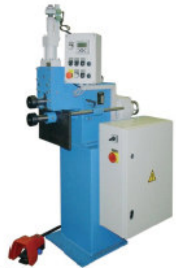
SME 100 silnikowa z hydraulicznym, równoległym dosunięciem walców
